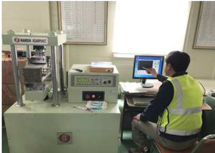
쏟크리트 휨인성시험 현황
